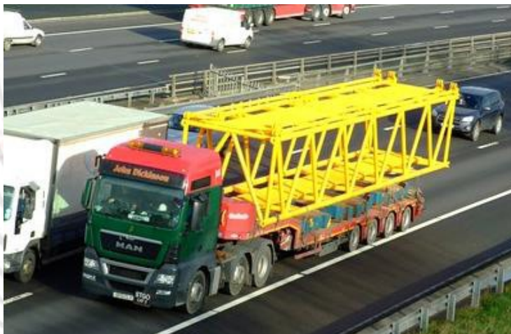
Gambar 19. Bagian Tower Crane yang Diangkut Melalui Jalan Raya
